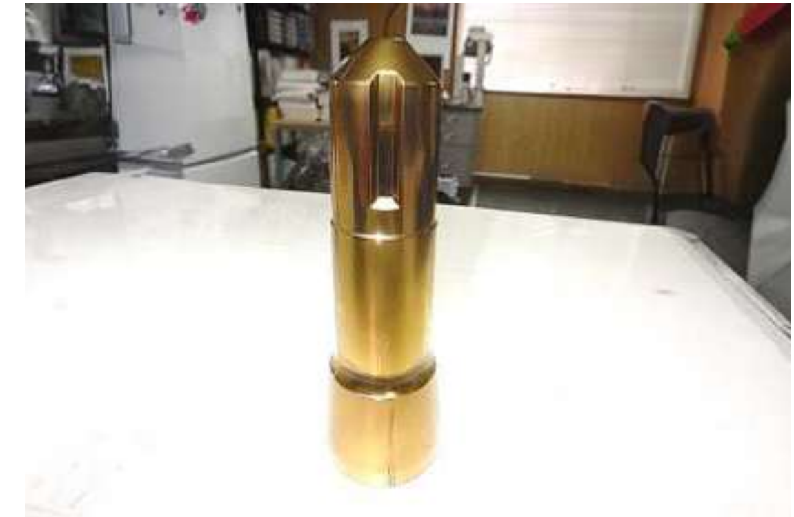
Punch φ60mm×149mm (AISI M2)
